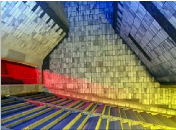
Bild: Feuerfeste Industrieofenauskleidung (Quelle: J+G)
