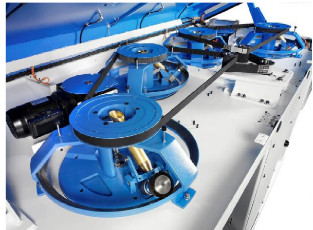
Bild: Patentierte Rosink High Production Coil Heads
