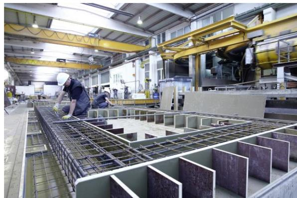
Bild: Herstellung von Betonsystemelementen
